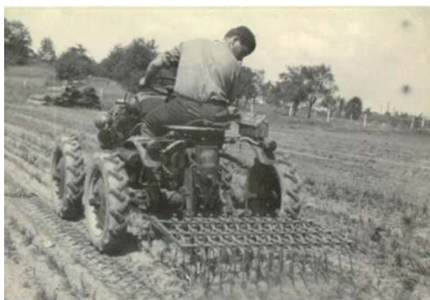
Obr. 1.71 Prstové brány zavěšené za malotraktorem sloužily ke kypření a pletí půdy. Velkoškolka Řečany nad Labem, šedesátá a sedmdesátá léta 20. století. (Archiv Lesoškolek, s. r. o., převzato z: http://www.lesoskolky.cz/profil-spolecnosti/ [cit. 5. 11. 2015])
