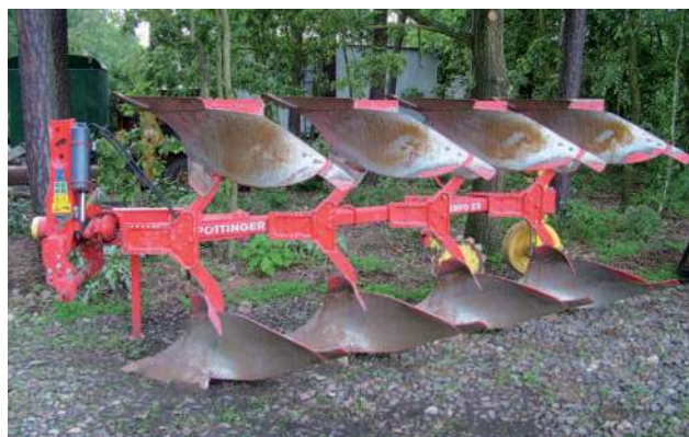
Obr. 2.57 Nesený otočný pluh Pöttinger využívaný k orbě půdy je součástí vybavení školkařských středisek specializovaných na produkci prostokořenných sazenic. Lesoškolky, s. r. o. (Foto autor)
