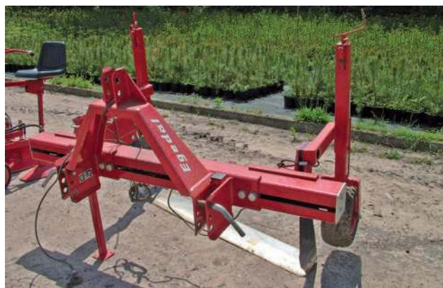
Obr. 2.74 Pasivní šikmý nůž pro podřezání kořenů sazenic firmy Egedal typ BRS. (Foto autor)
