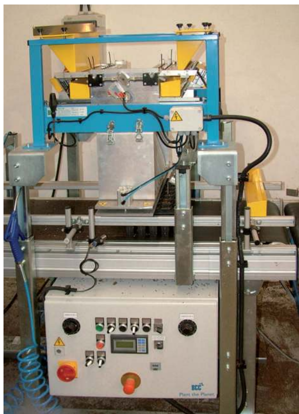
Obr. 2.96 Osevní zařízení na plnicí lince sadbovačů vyráběné firmou BCC ve Švédsku. Firma Lescus Cetkovice, s. r. o. (Foto autor)
