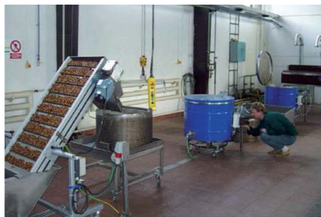
Obr. 4.15 K eliminaci povrchové a vnitřní mykoflóry na žaludech a bukvicích je Semenařský závod vybaven zařízeními k provádění termoterapie. (Foto archiv SZ LŠR, s. p.)
