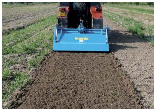
Obr. 2.68 Kultivátor a srovnávač povrchu záhonů firmy Imans určený do menších školek. (Foto autor)
