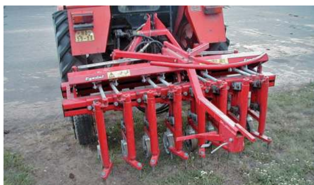
Obr. 2.73 Aktivní prstová plečka firmy Egedal. (Foto autor)
