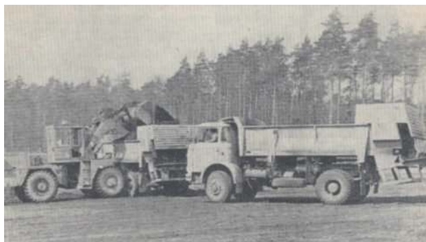
Obr. 1.56 Nakládání kompostové kůry nakladačem UNK 320 na nákladní auta s rozmetadly – rok 1969. (Archiv autora)
