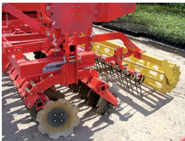
Obr. 2.59 Ukázka moderních mechanizačních prostředků ve velkých lesních školkách – detail diskového podmiťáče Terradisc. (Foto autor)
