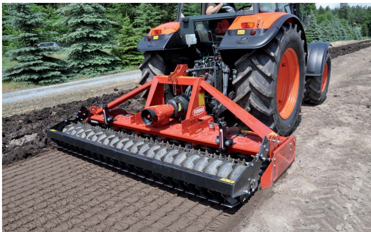
Obr. 2.70 Kultivační vibrační válec firmy Forigo slouží k finální úpravě povrchu záhonů. (Foto autor)
