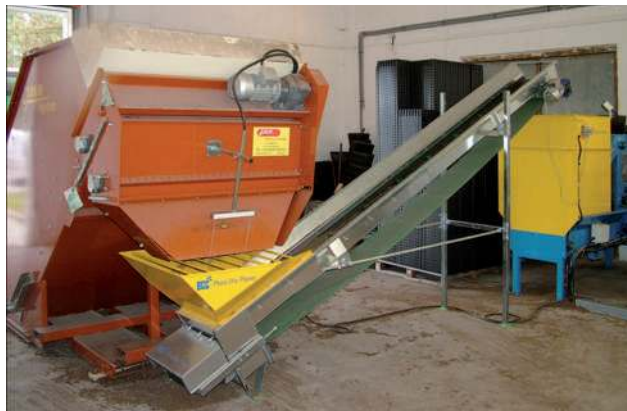
Obr. 2.94 Zásobník na pěstební substrát (typ Javo) a pásový dopravník jsou první strojní mechanizovanou součástí plnicí linky sadbovačů ve specializovaných lesních školkách. Vojenské lesy a statky, s. p., Středisko obalované sadby Lhota. (Foto autor)
