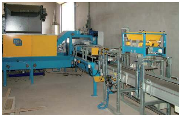
Obr. 2.95 Automatická plnicí a osevnická linka sadbovačů vyráběná firmou BCC ve Švédsku. Firma Lescus Cetkovice, s. r. o. (Foto autor)
