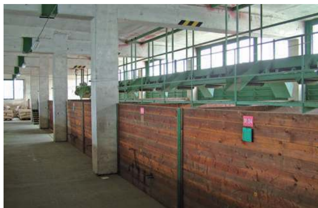
Obr. 4.07 Semenářský závod v Týništi nad Orlicí, komorový sklad jednotlivých dodaných oddílů šišek. (Foto autor)
