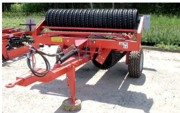
Obr. 2.62 Ukázka moderních mechanizačních prostředků ve velkých lesních školkách – diskový válec závěsný za traktor v přepravní poloze. (Foto autor)
