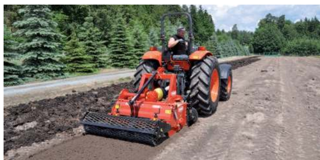
Obr. 2.71 Kultivátor italské firmy Forigo duplex je určen pro hlubokou přípravu půdy s dvojitou kultivací. (Foto autor)
