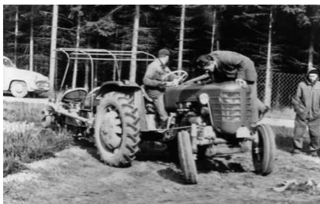
Obr. 1.28 Jeden z prvních školkovacích strojů v našich lesních školkách ověřovaný v padesátých letech 20. století na někdejším rozvojovém lesním závodě Rájec-Jestřebí. Do praxe zaváděný školkovací stroj byl tažen traktorem značky Zetor. (Archiv autora, foto Jindřich Moudrý)
