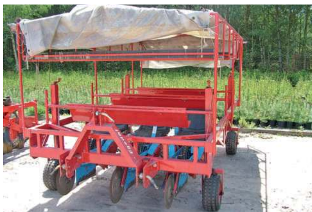
Obr. 2.65 Školkovací stroj Typ M firmy Egedal je univerzální pěti a sedmiřádkový školkovací stroj určený pro školkování mnoha druhů a výšky sazenic. Stroj je určen pro práci v náročnějších půdních podmínkách. (Foto autor)
