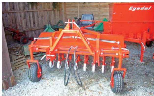
Obr. 2.63 Aktivní prstová plečka firmy Egedal. V pozadí zasypávač výsevů Egedal Typ 2M3 s míchadlem a pohonem od kola stroje. (Foto autor)
