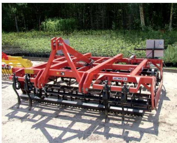
Obr. 2.60 Ukázka moderních mechanizačních prostředků ve velkých lesních školkách – víceoperační rotační brány. (Foto autor)
