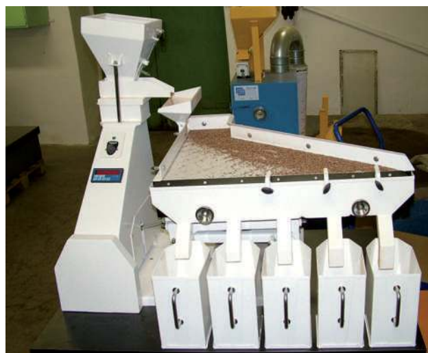
Obr. 4.09 Vibrační separátor menších oddílů malých semen v Týništi nad Orlicí. (Foto autor)
