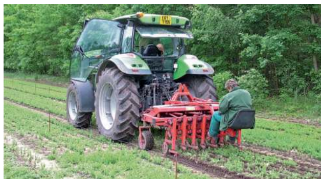
Obr. 2.64 Ukázka provozního nasazení aktivní prstové plečky Egedal. Lesoškolky, s. r. o., středisko Albrechtice. (Foto autor)
