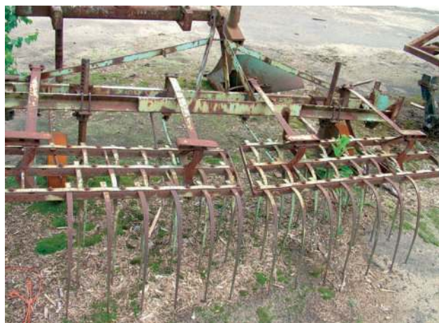
Obr. 1.48 Pružinový kypřič půdy upravený jako závěsný adaptér k traktoru. (Foto autor)
