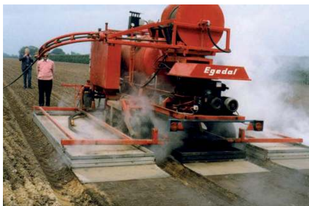
Obr. 2.75 Propařovací kolona k dezinfekci půdy od firmy Egedal. (Archiv autora)
