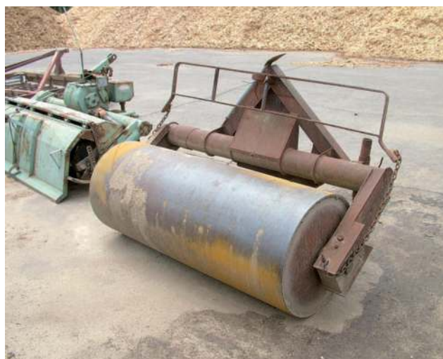
Obr. 1.52 Nesený půdní váleček k úpravě povrchu půdy na závěsném rámu za traktor. (Foto autor)
