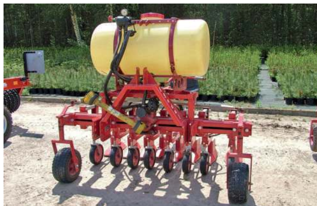
Obr. 2.72 Meziřádkový postřikovač, plečka a přihnojovač záhonů 3 v 1 Egedal typ GS. Na společný rám lze umístit adaptéry ve čtyř, pěti, šesti nebo sedmiřádkové verzi kombinující radličkové nebo prstové pasivní plečky s meziřádkovým postřikovačem a aplikátorem granulátů. Stroje je možné používat i zvlášť. Postřikovač GS je upraven pro nízkotlakou aplikaci postřikové jichy s ochrannými kryty. (Foto autor)
