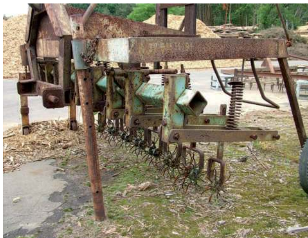
Obr. 1.51 Sada kypřících rotačních pleček (ježků) k meziřádkovému kypření půdy na záhonech. Je umístěna na společném závěsném rámu k traktoru. (Foto autor)
