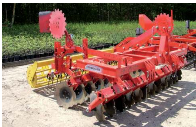
Obr. 2.58 Ukázka moderních mechanizačních prostředků ve velkých lesních školkách – diskový podmiťáč. Jde o kombinované víceoperační návěsné zařízení za traktor vykonávající přípravu půdy společným užitím diskových bran, pružinových pérových bran a válcovým drtičem hrud. (Foto autor)
