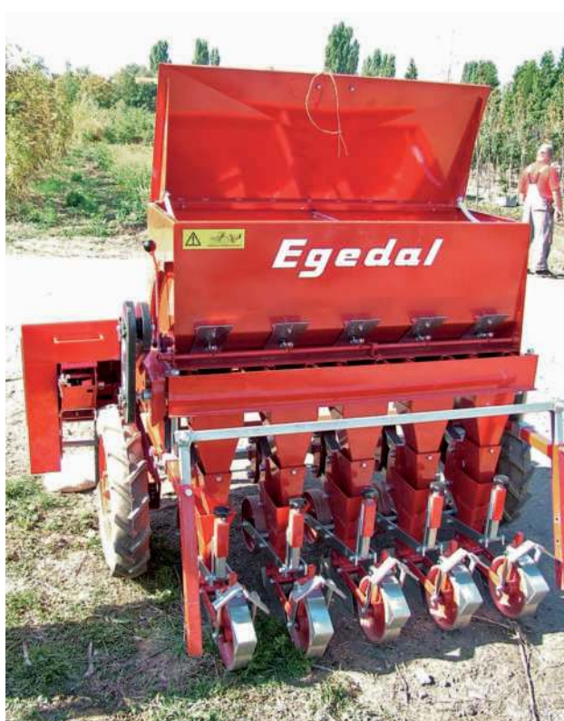
Obr. 2.76 Pětirádkový secí stroj od firmy Egedal. (Foto autor)
