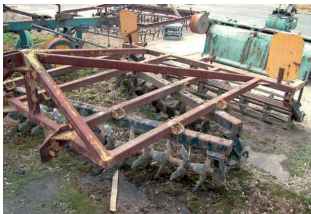
Obr. 1.49 Taliřový mulčovač půdy s podélnými rotačními branami na společném závěsném rámu k traktoru. (Foto autor)
