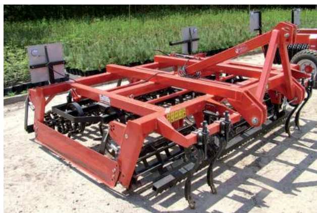
Obr. 2.61 Detail víceoperačních rotačních bran. (Foto autor)
